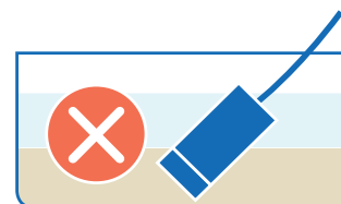
Illustration 2: Montage de la pompe, la pompe ne doit pas être dans la boue
